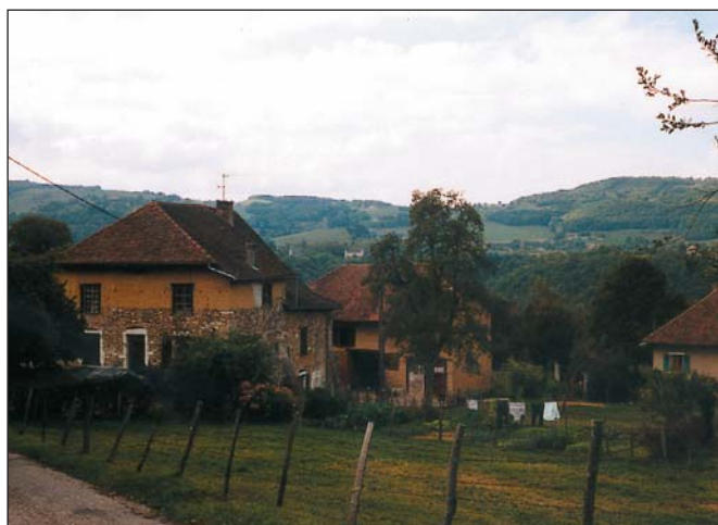
Les bâtiments en pisé sont construits sur une base en galets. Les deux techniques sont parfois utilisées sur un même bâtiment.
