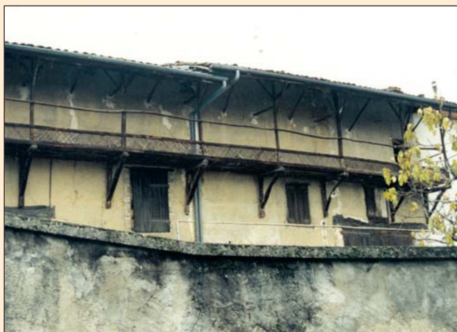
Le séchoir à noix qui court le long de la façade sous une dépassée de toiture est caractéristique de la région.
